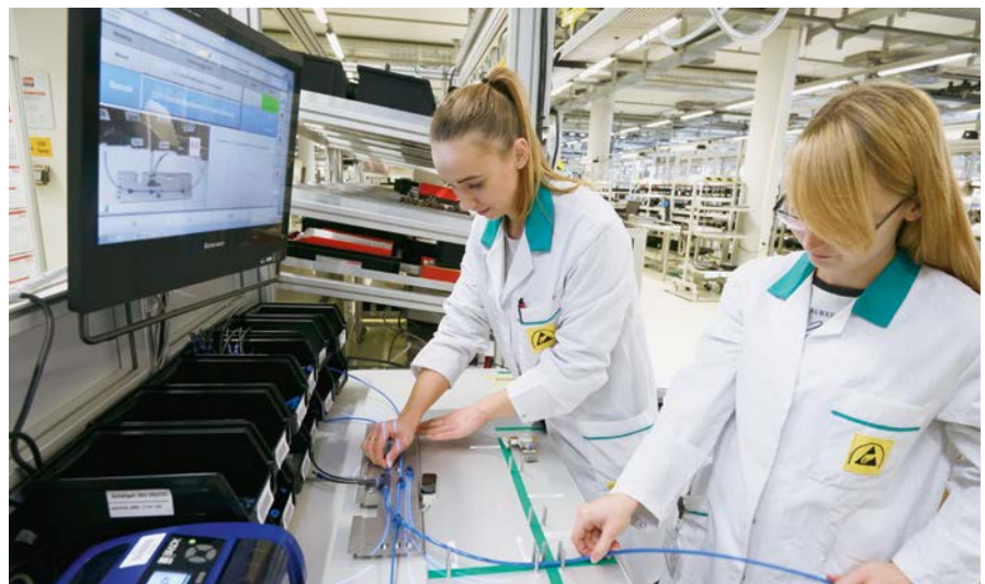
Fehler ausgeschlossen: Was wann exakt zu tun ist, zeigen Videoprojektionen.
